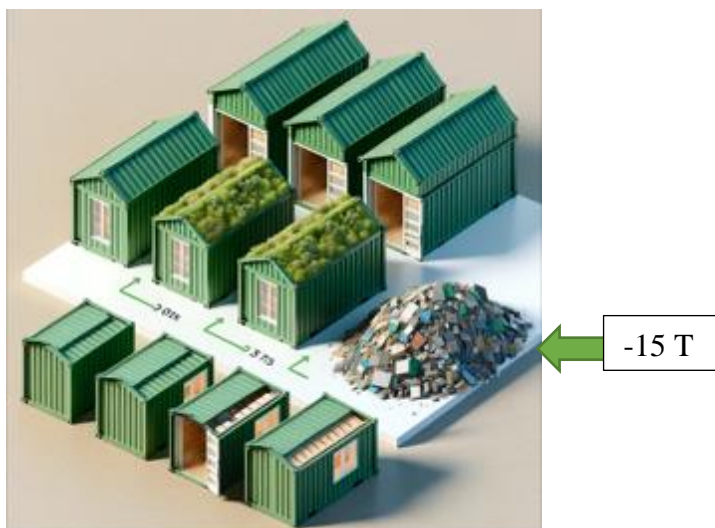
Slika 2: Za 151m 2 površine z ladijskimi kontejnerji je 15 ton manj gradbenih odpadkov kot pri klasični gradnji
