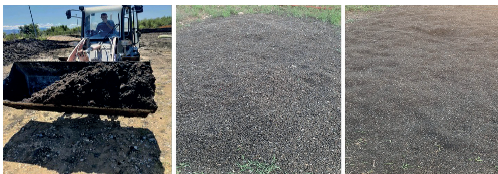
Slika 7: Izgled blata iz čistilne naprave in predelanega ter presejanega materiala na 10 mm in 5 mm
