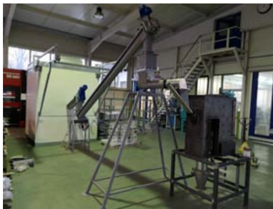
Slika 1: Pirolizna peč proti koncu razvojne faze.
