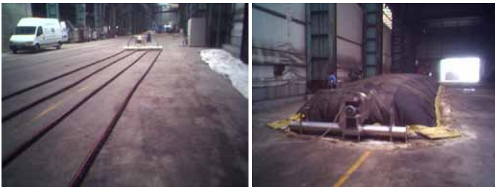
Slika 7: Prezračevalne cevi in prekrivna membrana Gore®Cover
