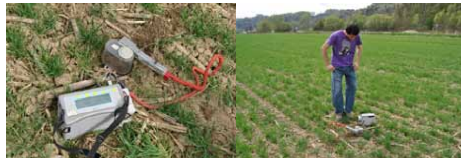
Slika 4: Merjenje CO 2 z merilno napravo LC PRO+ na lokaciji Podova dne 8. 4. 2011
