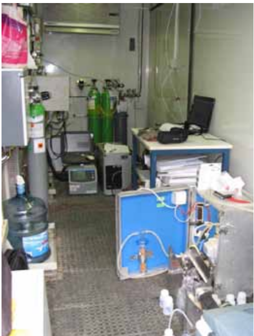
b) Merilni sistem za občasne meritve emisij snovi v zrak
