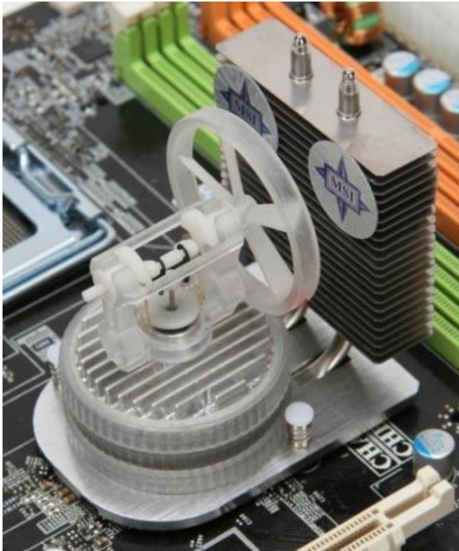
Slika 7: MSI-jev hladilni sistem s stirligovim motorjem
