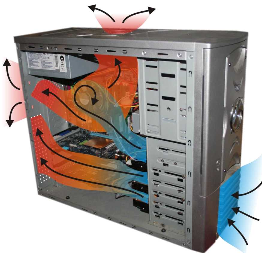
Slika 1: Pretok zraka skozi namizni računalnik
