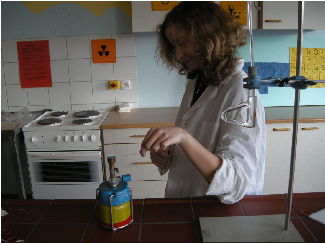
Slika 6: Priprava kapilar za določanje tališča
