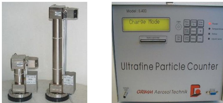
Slika 4. Dve različici naprave DMA (levo) manjša je namenjena merjenju manjših delcev, večja pa za merjenje večjih delcev. Na sliki desno je naprava CPC.
