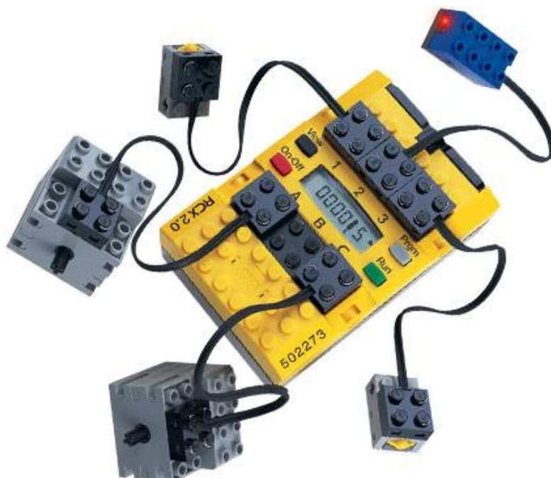
Slika 5: Krmilni del robota
