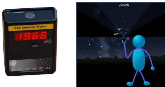
Slika 50: a Sky Quality meter (Vir:Unihedron, 2013); b prikaz izvajanja meritev (Vir: Unihedron, 2013 )
