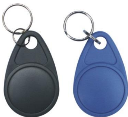
Slika 2: Passivna RFID priponka
