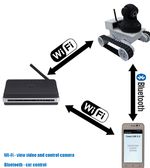
Slika3 Funkcionalna shema delovanja sistema
