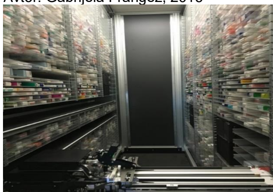
Slika 26: Robotizirano skladiščenje zdravil Avtor: Gabrijela Frangež, 2016
