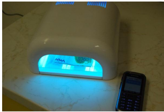
Slika 10: Obsevanje volnene tkanine z UV svetlobo. (Vir: Detiček A., 2016)
