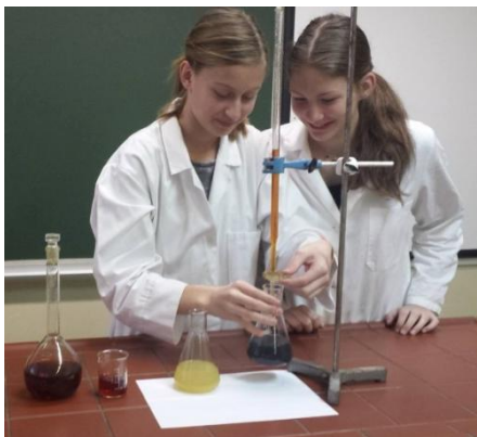
Slika 12: Titracija vzorca do nastanka modre kompleksne spojine (Jambriško, 2016)
