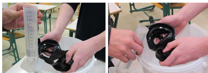
Slika 14: Merjenje volumna votlih delov potapljaške maske. (Avtor: Jurij Hojnik)
