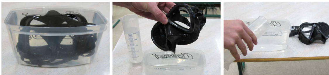
Slika 13: Merjenje volumna potapljaške maske. (Avtor: Jurij Hojnik)
