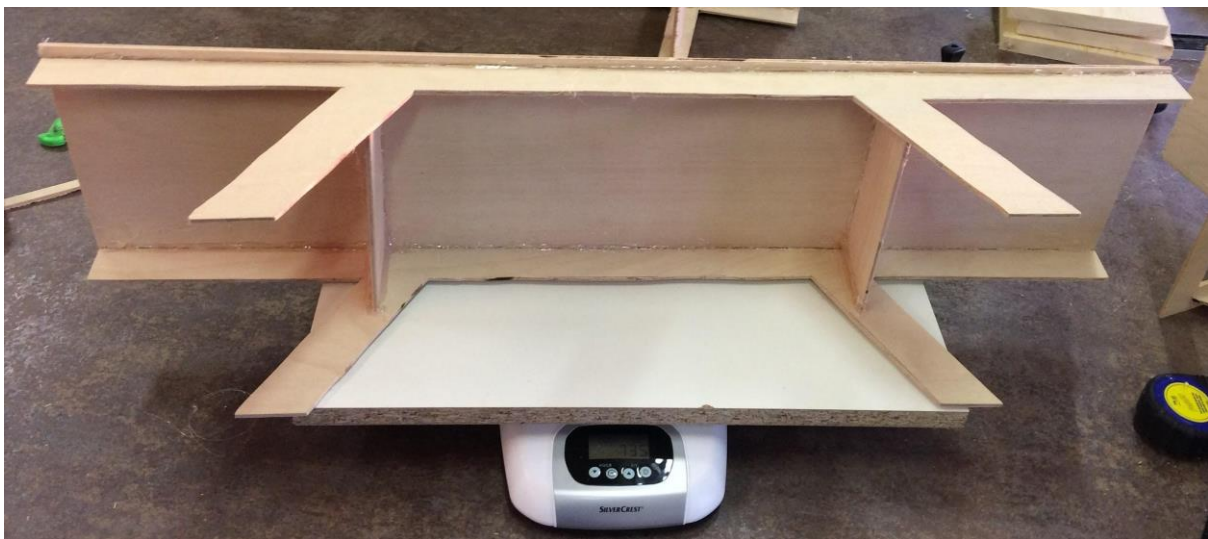
Slika 15: Tehtanje okvirnega mostu s poševnimi stebri.
