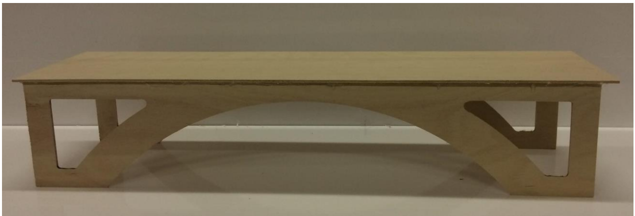
Slika 7: Maketa ločnega mostu.
