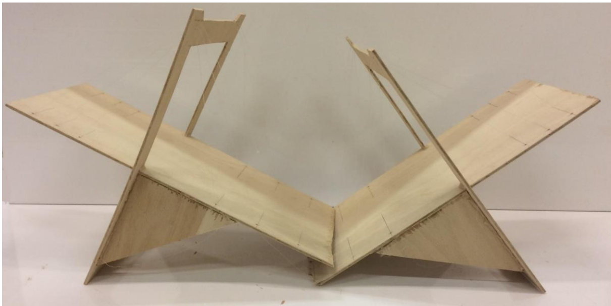
Slika 22: Zlomljen most s poševnimi zategami.
