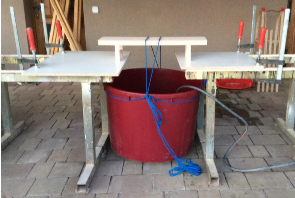
Slika 16: Preverjanje nosilnosti grednega mosta.
