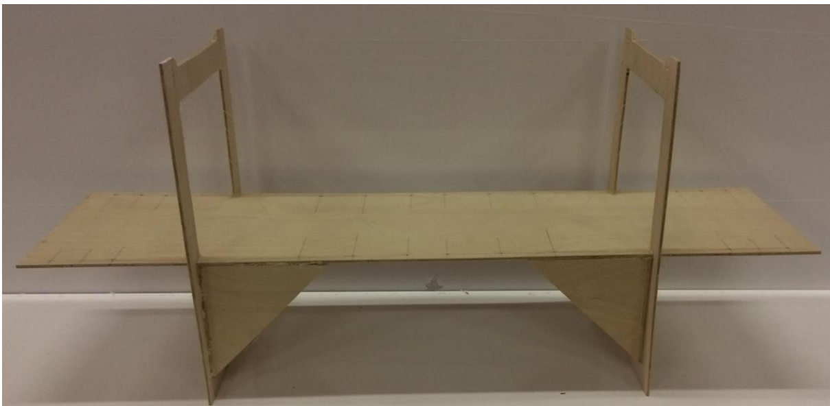
Slika 11: Maketa mosta s poševnimi zategami.
