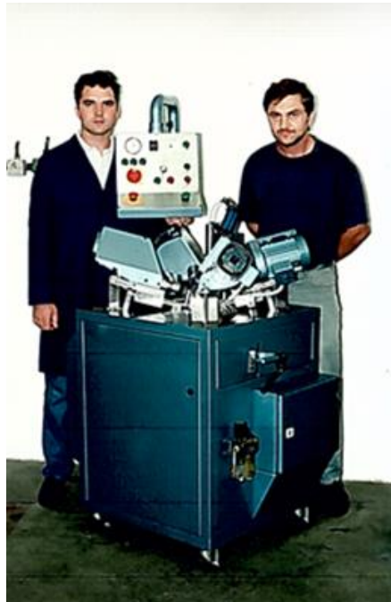
Slika 11: Avtomatski stroj za vrtanje plinskih gorilnikov. (KEV, 1993)
