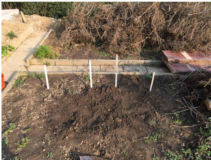
Slika 8: Prikaz izvedbe poskusa razgradljivosti vrečk v tleh. (Avtor: Lan Žnidar, 2018)
