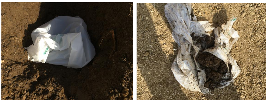
Slika 21 in slika 22: Biorazgradljiva vrečka, preden smo jo zakopali v prsti (levo) in po izkopu čez pol leta (desno). (Avtor: Lan Žnidar, 2018)
