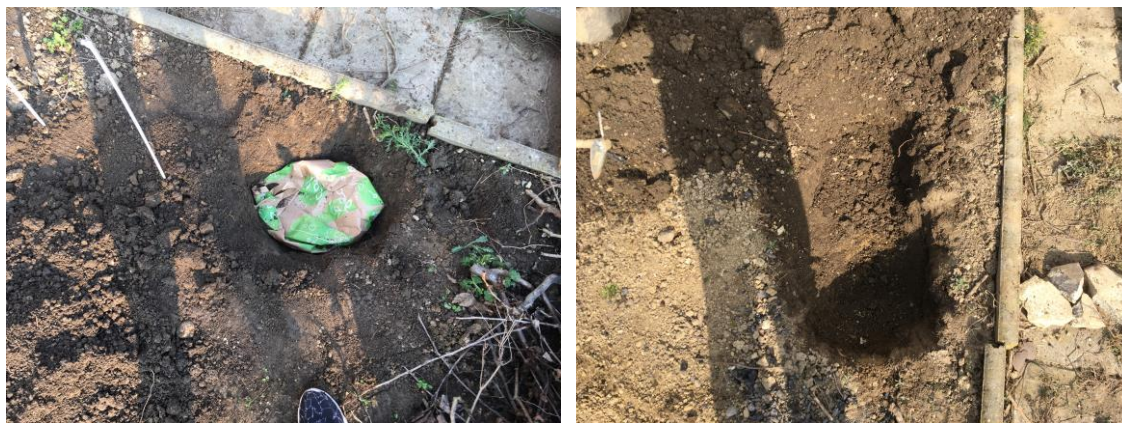
Slika 23 in slika 24: Vrečka iz papirja, preden smo jo zakopali v prsti (levo) in po izkopu čez pol leta (desno). (Avtor: Lan Žnidar, 2018)
