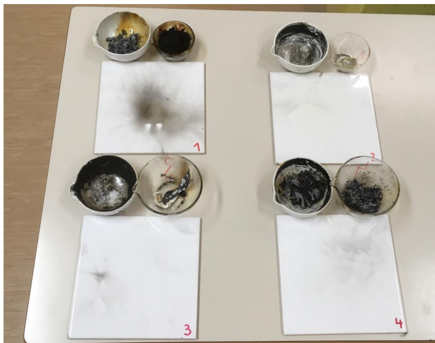
Slika 13: Ostanek po sežigu vrečk v izparilnicah in saje, ki so nastale med sežigom na belih ploščicah. (Avtor: Luka Podvršnik, 2018)
