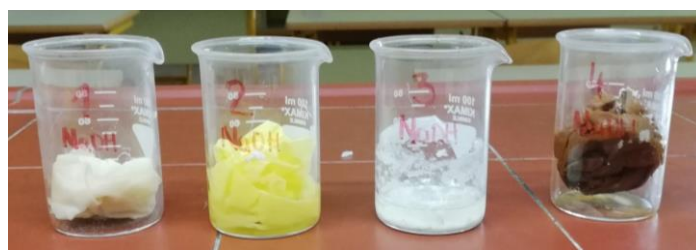
Slika 15: Vrečke po dveh tednih namakanja v kislini – levo. (1 - vrečka iz blaga, 2 - plastična vrečka, 3 - biorazgradljiva vrečka, 4 - papirnata vrečka). (Avtor: Luka Podvršnik, 2018)
