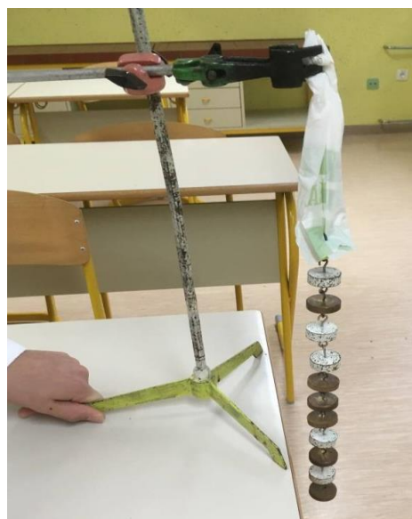
Slika 3: Prikaz izvedbe poskusa nosilnosti vrečk. (Avtor: Luka Podvršnik, 2018)
