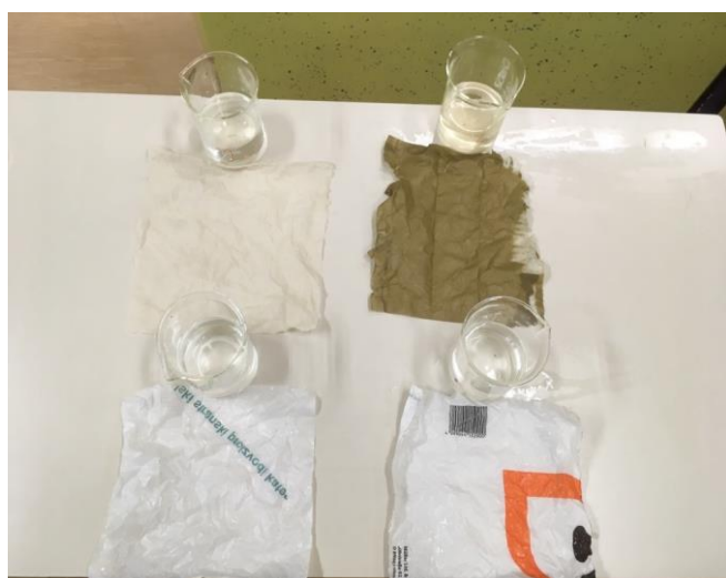
Slika 14: Vrečke po 30 minutah v vroči vodi. Vrečka iz blaga (levo zgoraj), papirnata vrečka (desno zgoraj), bio vrečka (levo spodaj) in plastična vrečka (desno spodaj). (Avtor: Luka Podvršnik, 2018)
