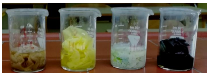
Slika 15: Vrečke po dveh tednih namakanja v kislini – levo. (1 - vrečka iz blaga, 2 - plastična vrečka, 3 - biorazgradljiva vrečka, 4 - papirnata vrečka). (Avtor: Luka Podvršnik, 2018)
