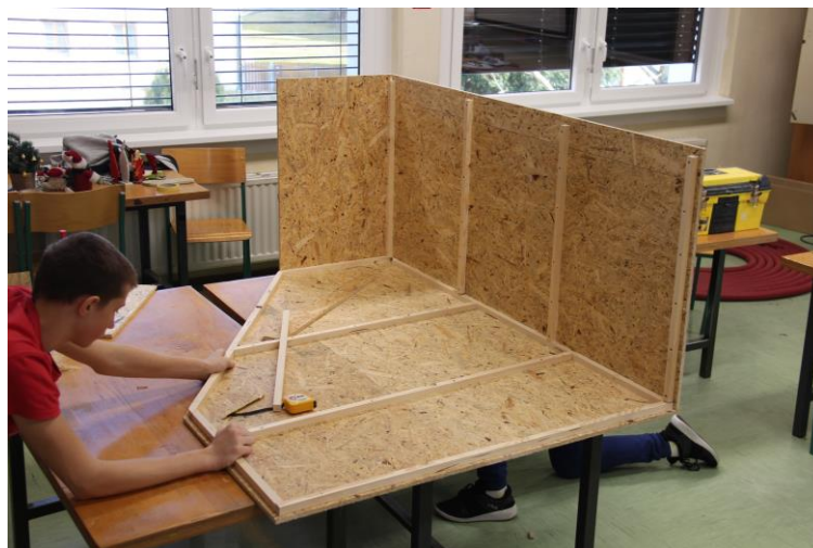
Slika 11: Sestavljanje ohišja glasbila. (Slikovni viri: Slika 11).
