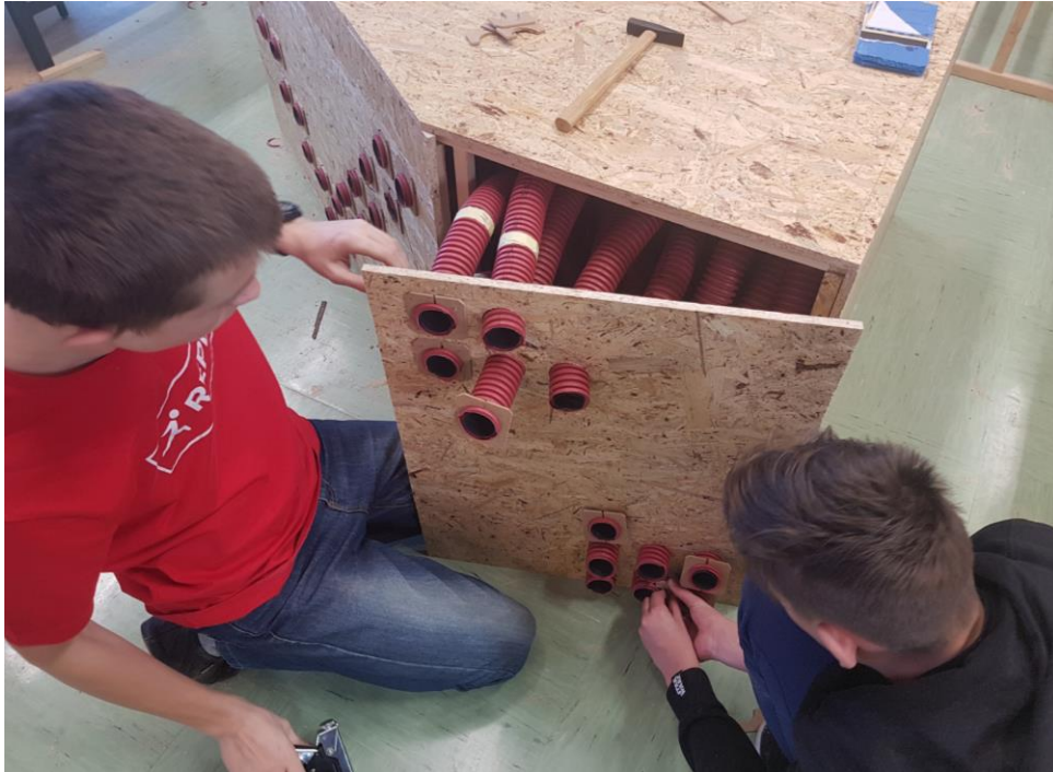
Slika 17: Pritrjevanje zadnje stranice glasbila. (Slikovni viri: Slika 17).
