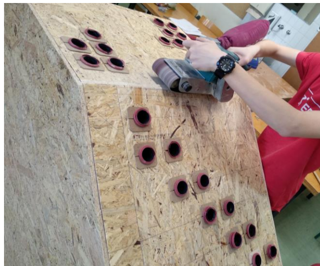
Slika 12: Brušenje ohišja z el. ročnim tračnim brusilnim strojem. (Slikovni viri: Slika 12).
