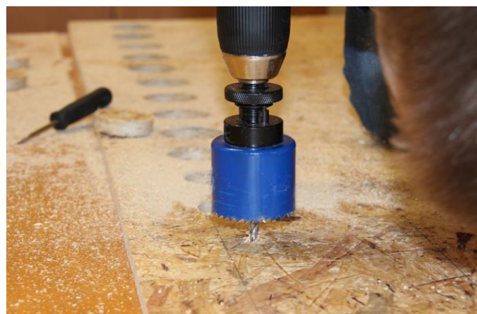
Slika 13: Vrtanje lukenj s kronskim svedrom. (Slikovni viri: Slika 13).
