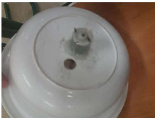
Slika 17: Motorček, pritrjen na plastično posodo. (Foto: Renata Kovačič, 2019)
