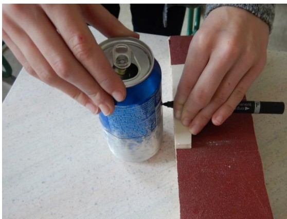
Slika 15: Prenašanje mere na pločevinko. (Foto: Gaia Jelen, 2019)
