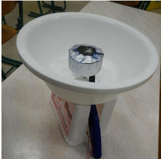
Slika 19: Izdelan aparat za izdelavo sladkorne pene s segrevanjem. (Foto: Renata Kovačič, 2019)
