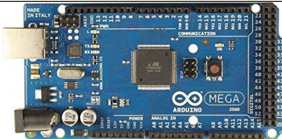
Slika 3: Arduino Mega 2560 strojna platforma (vir: www.amazon.com )
