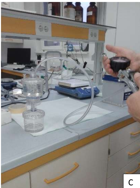
Slika 64: (A) Filter iz steklenih vlaken; (B) Naprava za filtriranje vode (tlačna); (C) Filtriranje vode z ročno tlačilko; (D) Filter po filtriranju. (Foto: Filip Teo Vidovič)
