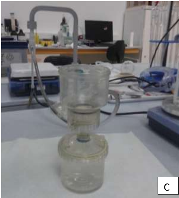
Slika 68: (A) Tehtnica; (B) Filter, ki smo ga uporabili za vodo iz vzorca 1; (C) Naprava za filtriranje; (D) Oba filtra v posodici. (Foto: Filip Teo Vidovič)
