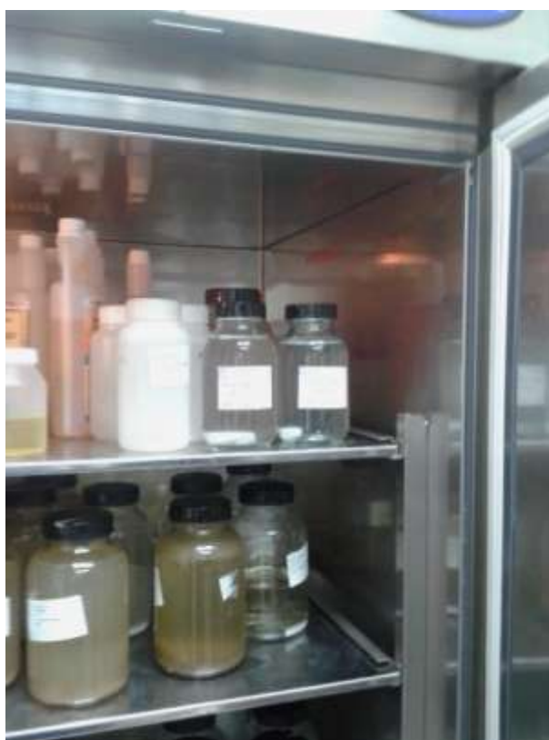
Slika 63: Posodi za KPK in celotni P v hladilniku. (Foto: Filip Teo Vidovič)
